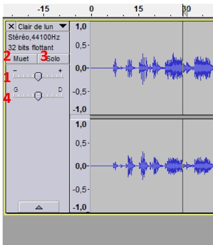
Le **volume** du son qu'on écoute est représenté par le vu-mètre. Il ne doit pas dépasser le 0 de la fin de barre, sinon des barres rouges s'affichent.
